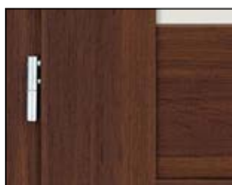
Tři dvoučepové závěsy usazené v rámu s možností regulace. Mírně zaoblené hrany dveří, na hraně nejsou žádné spoje, což přispívá k delší životnosti dveří
