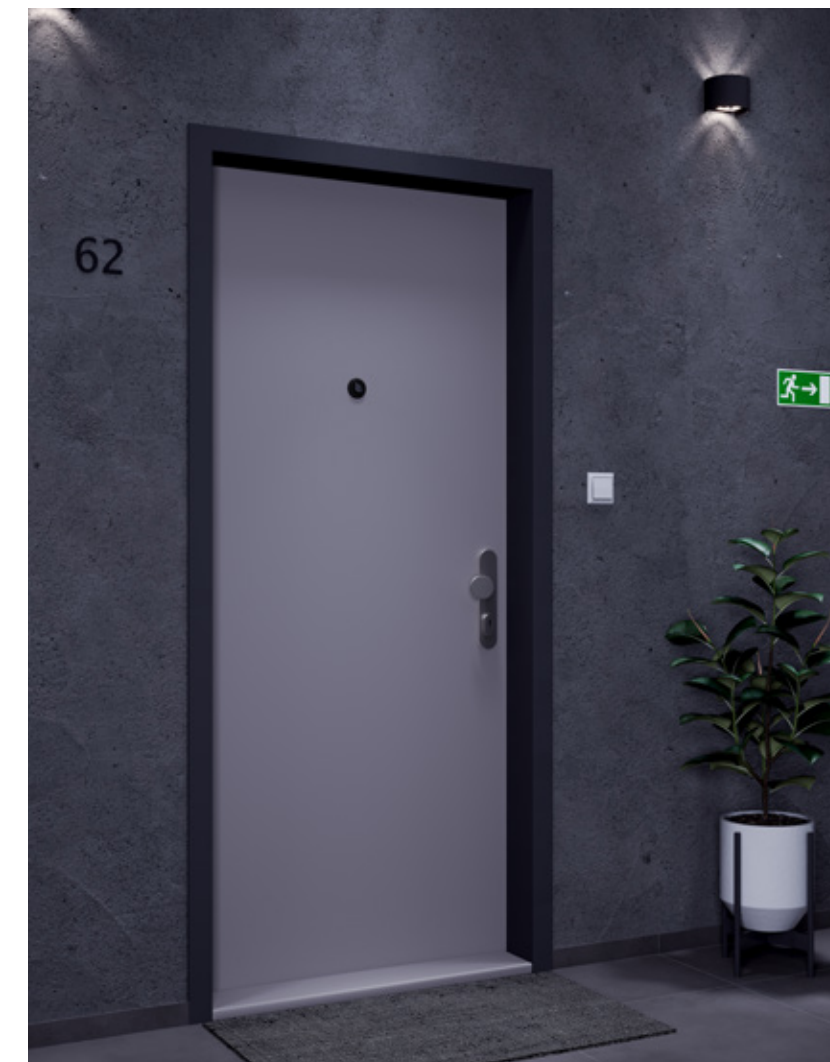
pohled z chodby: Provedení ELEGANT 10 - CPL šedá U788, kovová zárubeň SAP 864 - RAL 7016, protipožární odolnost 30 min, bezpečnostní třída RC2, zvukový útlum 32 dB a odolnost klima II, bezpečnostní kování 13, kukátko
